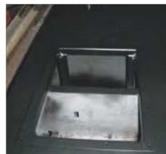
▲ Frangiflutti interni al serbatoio per ridurre lo spostamento di carburante
