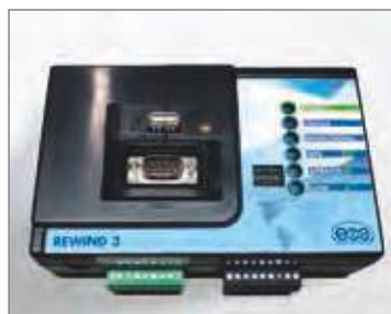
▲ Unità di controllo REWIND3 e monitoraggio remoto (ECIE ELECTRONICS)
