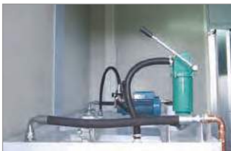
▲ Kit rabbocco automatico montato su serbatoio con capacità maggiorata
