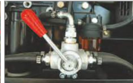
▲ Valvola deviatrice per serbatoio esterno
